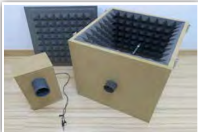
Figura 3. Fuente emisora y cámara receptora.
