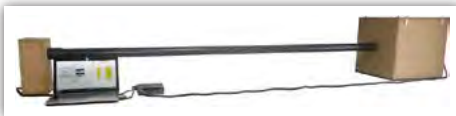
Figura 5. Sistema de medición de pérdidas por inserción (instalación prototipo).
