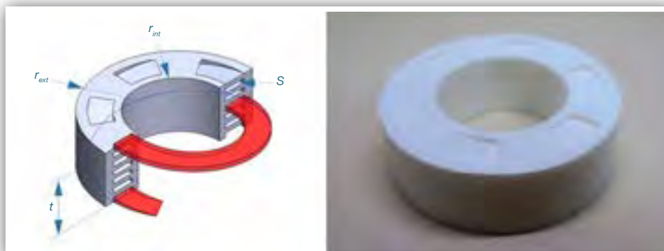
Figura 6. Geometría de silenciador metamaterial y prototipo fabricado mediante impresión 3D.
