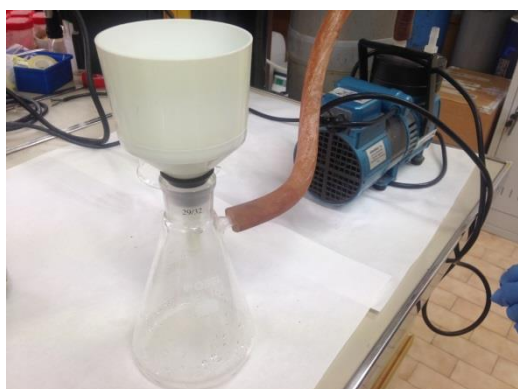
Figura 3. (a) Dispositivo de filtración a vacío. (b) Aspecto del extracto después de filtrarlo.
