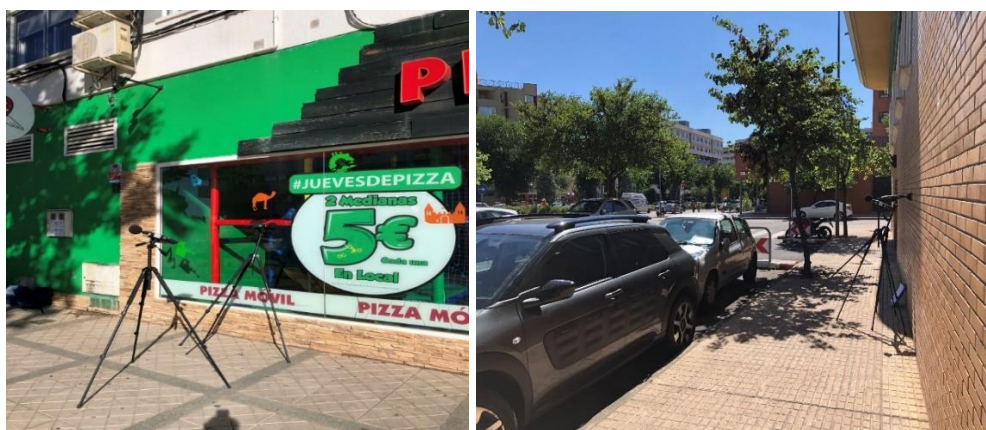
Figuras 2 y 3: Colocación de los micrófonos en algunos de los puntos de medida
