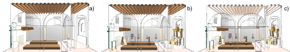
Figura 4. Modelos en 3D de la capilla para las simulaciones acústicas: a) en su estado original; b) tras las intervenciones arquitectónicas entre los siglos XVIII y XIX; y c) en su estado actual.
