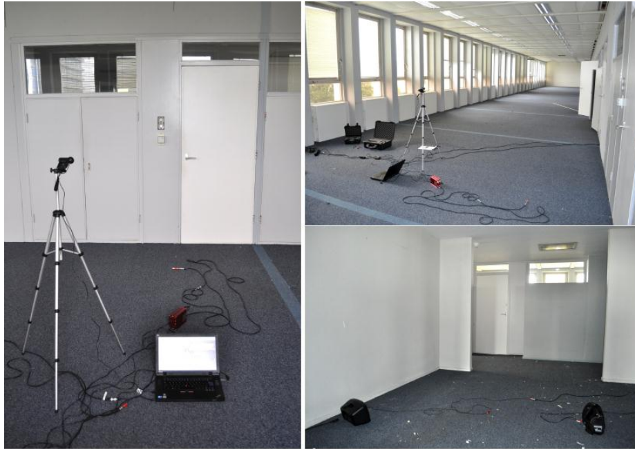
Figura 1 - Fotos del montaje: superficie estudiada y equipo de medición (izquierda), entorno de medida (superior derecha), parte exterior de la sala (inferior derecha)
