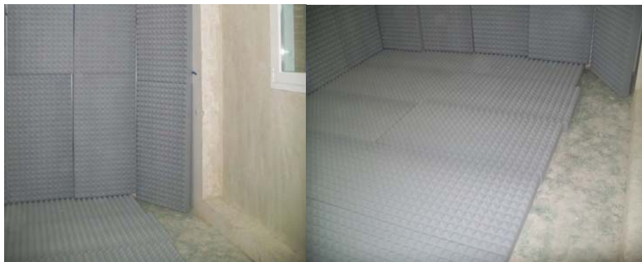
Figura 9. Detalle del corredor libre de paneles absorbentes delante del porta-muestras en la cámara de recepción
