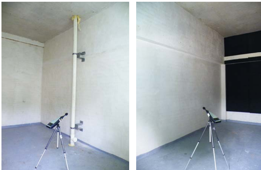
Figura 3. Fotografías de las cámaras de ensayo, emisión y recepción. Instituto Eduardo Torroja
