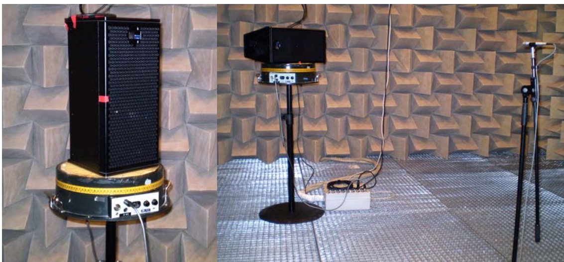
Figura 2. Fotografías: elementos del ensayo. Se visualiza la fuente en posición para la medida de los planos horizontal y vertical
