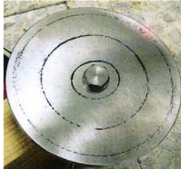
Figura 4. Prototipo de transductor ultrasónico de potencia de placa circular : a) diseñado por FEM, b) imagen del modo de vibración del transductor desarrollado con 3 CN obtenida mediante polvo metálico, y c) campo acústico generado por el transductor ultrasónico en el interior de la cesta simulado por FEM.
