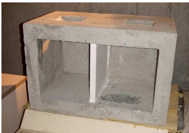
Figura 5: Modelo a escala con el tabique separador.
