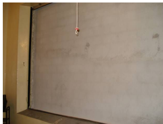
Figura 2 – Parede na câmara reverberante, para o teste de isolamento sonora.
