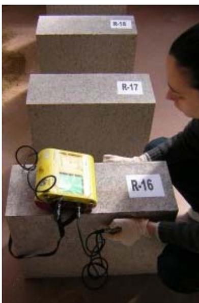
Figura 1: Ensayo transversal en muestra de granito Rosa Porriño
