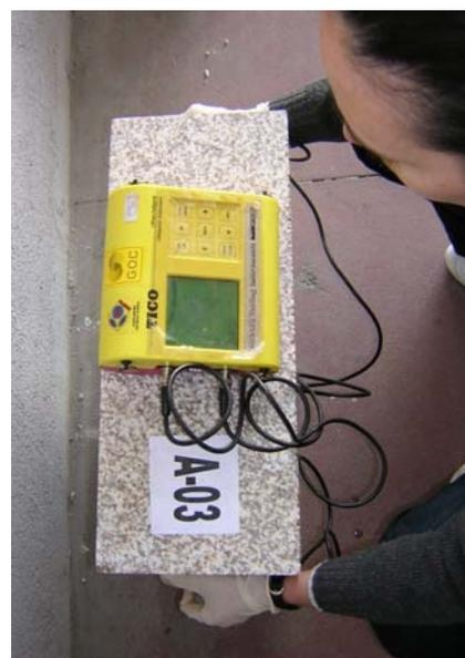
Figura 2: Ensayo longitudinal en muestra de granito Albero
