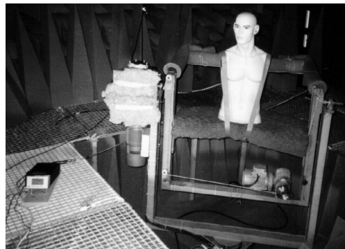
Figura 1: Configuración experimental para la medida de las funciones HRTF en cámara anecoica
