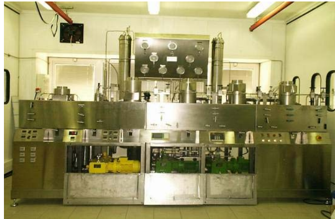
Figura 2. Planta piloto de extracción con CO 2 supercrítico
