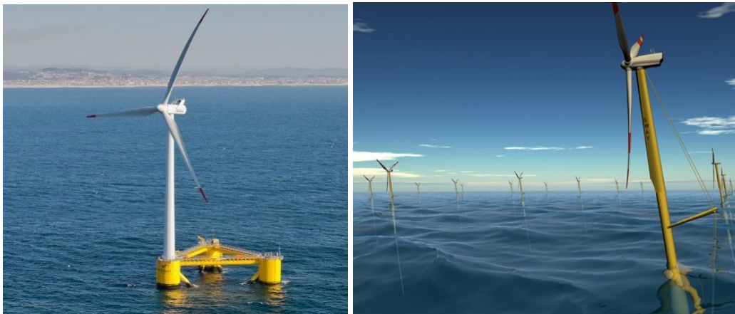
Figura 6. Sistemas de aerogeneradores flotantes: a la izquierda el prototipo Windfloat 1 instalado en junio de 2012 frente a Póvoa do Varzim (Portugal); a la derecha, una idealización del sistema noruego Sway, basado en boyas con contrapesos profundos.
