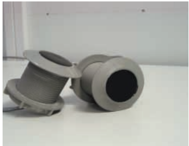
Figura 5: Transductores de Titanato de Bario de frecuencia de resonancia a 200 KHz.
